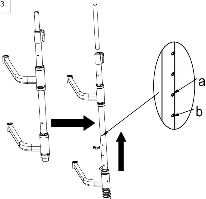
Соберите раму как показано выше. Отрегулируйте высоту рамы с помощью отверстий а и b.
